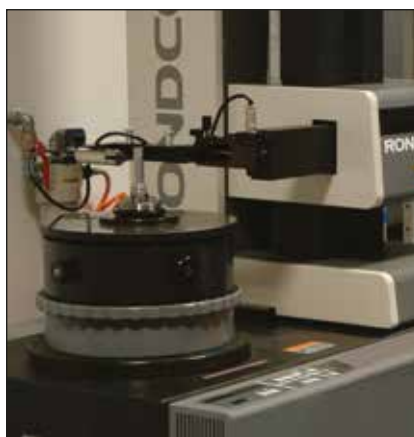
Messung der Rotorkonzentrität für einen vibrationsfreien Betrieb
